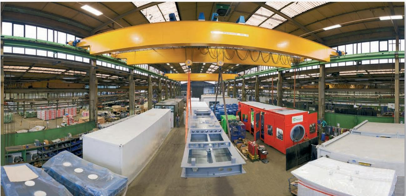
Für stationäre Industrieanwendungen fertigen wir diesel- und gasbetriebene Einheiten in Sonderausführung nach Kundenwunsch, so zum Beispiel containerisiert, für Offshore- oder Ölfeldanwendungen, oder in explosionsgeschützter Ausführung. Hocheffiziente Blockheizkraftwerke für alle Arten von Kraftstoffen gehören zu unserem Tagesgeschäft.
